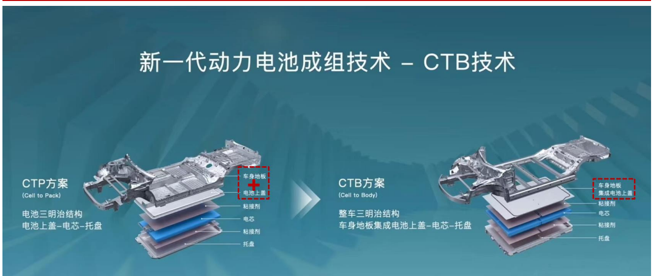
图 56: 比亚迪 CTB 技术对比 CTP 技术的变化
