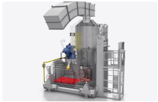
图 71：可以反复重新熔炼的铝合金熔炼炉
