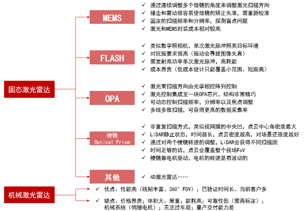
图 22: 激光雷达分类(按旋转方式划分): 体现出技术的百花齐放
