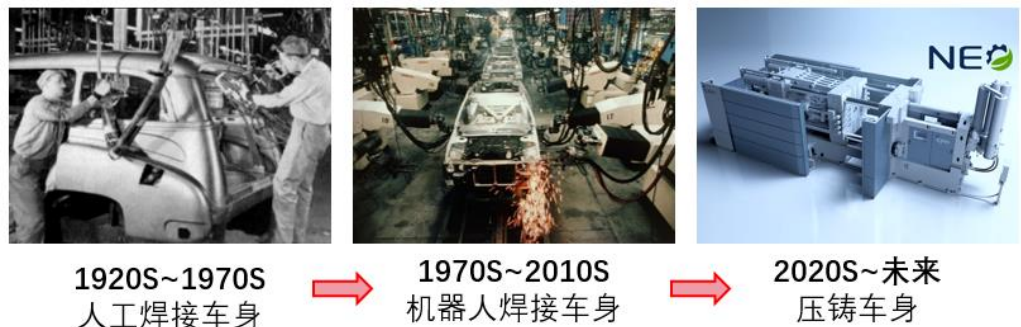
图 66：汽车白车身制造工艺及核心装备演变趋势
