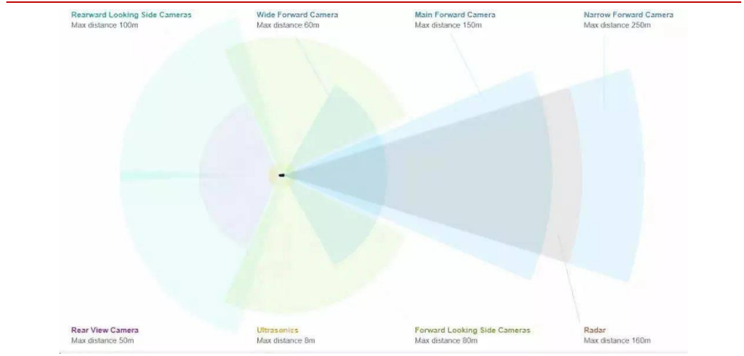
图 16：特斯拉的三目摄像头分别覆盖了不同的视角和距离
