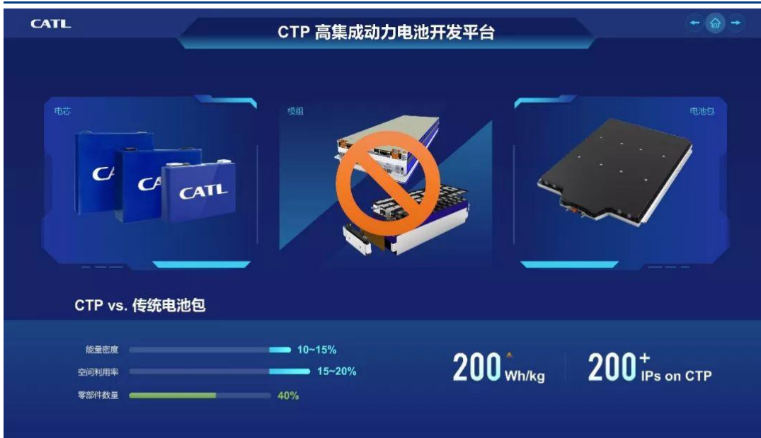
图表 16 宁德时代 CTP 动力电池开发平台于传统电池包比较
