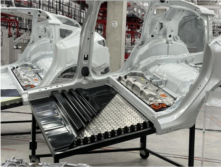
图：Tesla 底盘中大圆柱电池排布情况
