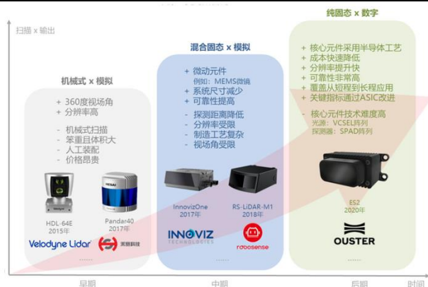
图 67: 激光雷达从模拟机械式向数字固态化发展
