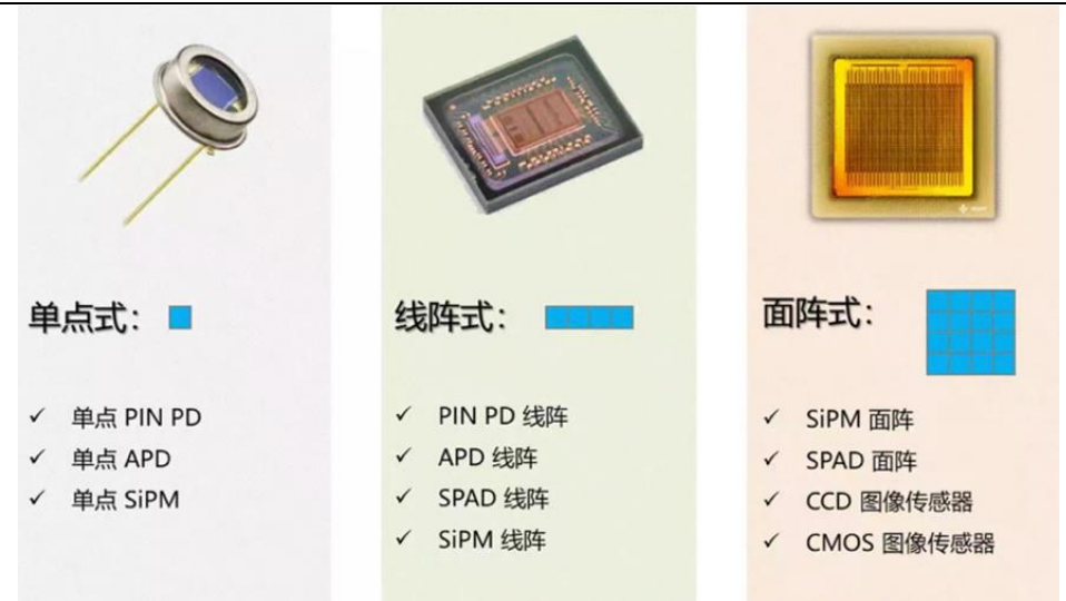
图 66: 应用于激光雷达的光电探测器从“点”向“面”进化并普及
