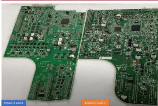
图 16: model Y 控制器元件间距明显更小
