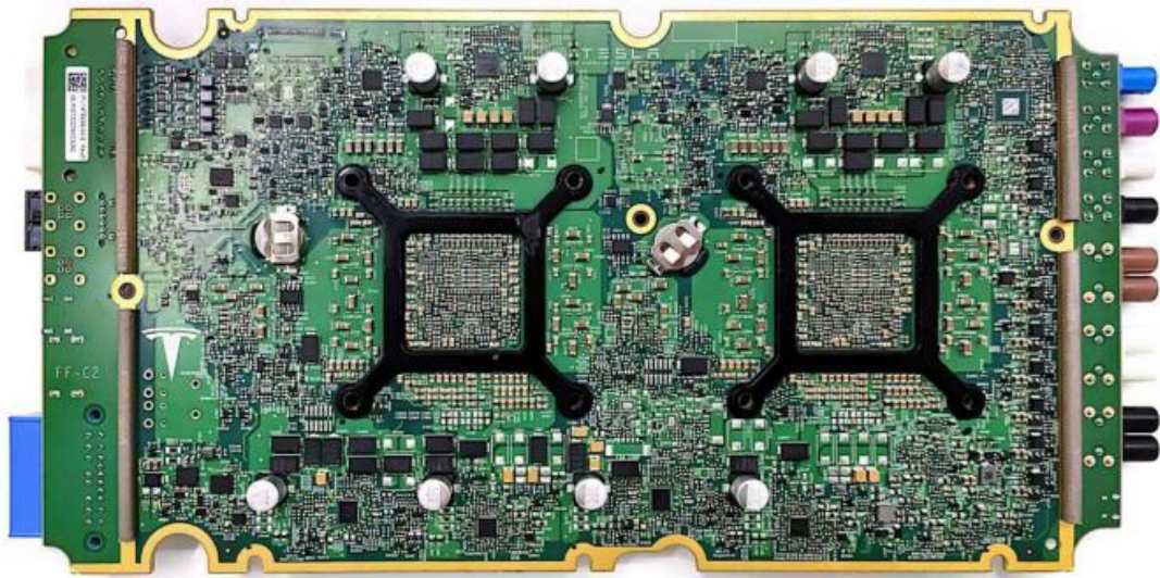
图 22：特斯拉 model 3 自动驾驶域控制器电路板背面被动元器件非常密集
