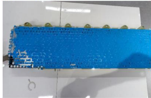
图 105：特斯拉电池包中采用的灌密封胶
