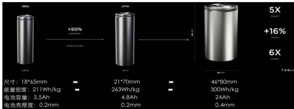
图 109: 18650、2170、4680 电池尺寸及能量密度对比
