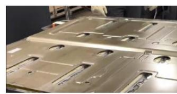
图 108：Rivian 电池阻燃设计——金云母
