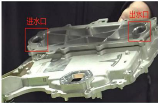
图 44: 逆变器壳体散热结构进水口与出水口实物图
