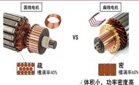
图 118：圆线电机 vs 扁线电机
