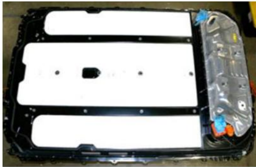
图 104：特斯拉电池包中的防火泡棉
