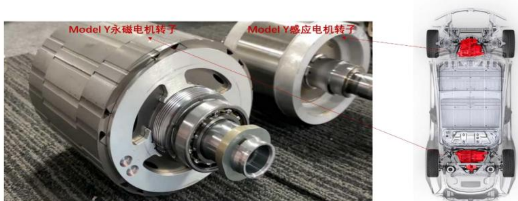
图 114：特斯拉 Model Y 双电机版本采用前感应电机/后永磁电机的动力总成布局
