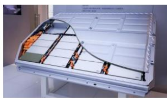
图 107：极狐阻燃设计——陶瓷纤维防火毯
