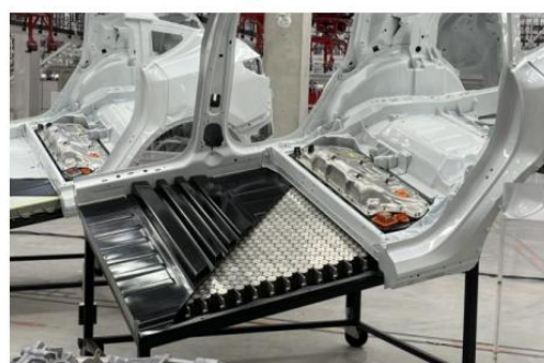
图 88: 特斯拉展示的无模组结构化电池包方案
