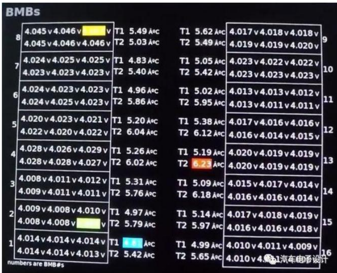
图 53：特斯拉 model S 诊断界面显示的电池组温度电压采样信息
