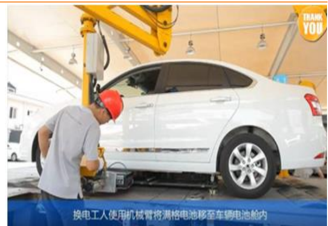
图 8：分箱换电中工作人员将电池放入电池槽
