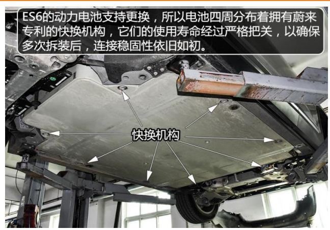
图 6：蔚来 ES6 汽车快换机构示意图
