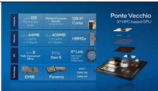
图 104: 英特尔 GPU Max 系列通过 Chiplet 技术实现晶体管数量超过 1000 亿个
