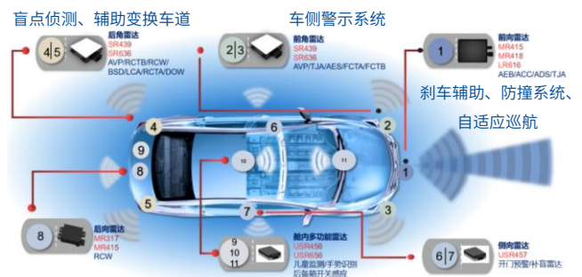
图 36: 车辆的前向、后向、侧向、四角以及座舱内均可搭载毫米波雷达并实现不同功能
