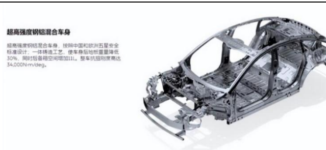
图 91: 一体化压铸后底板使蔚来 ET5 后备箱空间增加了 11L
