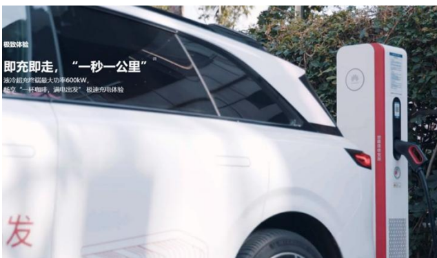
图 20：华为新一代全液冷超充最高支持 1000V 电压和最大 600 kW 功率
