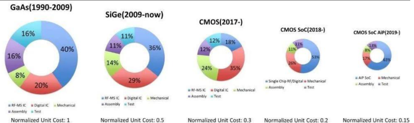
图 41：毫米波雷达成本在“CMOS+AiP+SoC”工艺的带动下成本降低至第一代 GaAs 方案的 15%
