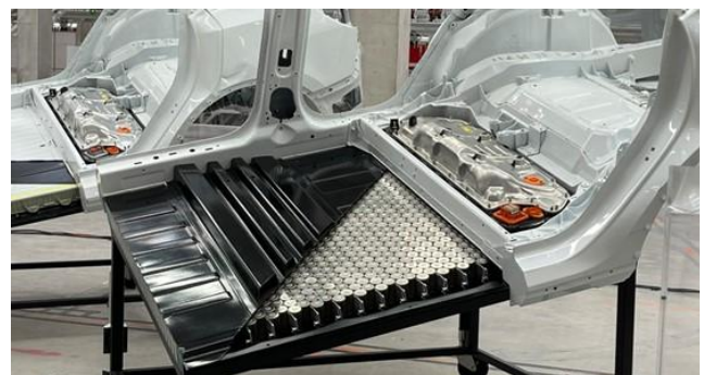
图 98: 特斯拉 CTC 方案彻底取消传统的模组和电池包设计
