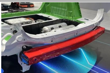
图 90: 极氪 009 针对压铸后端铝车身设计额外的四段式碰撞分区
