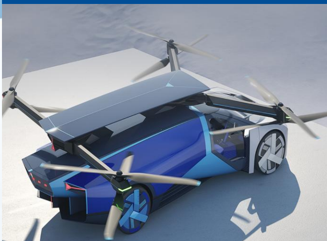
图：小鹏汇天陆空一体式飞行汽车，实现陆行、飞行功能自由切换
