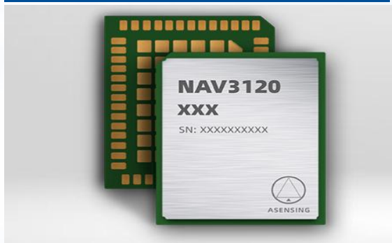
图：高精度GNSS模组NAV3120系列及特点
