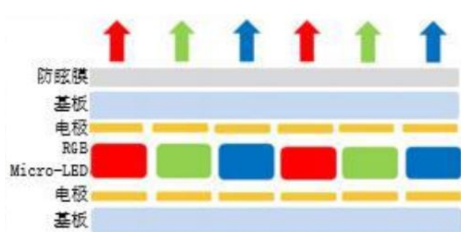
图 7：Micro LED显示结构
