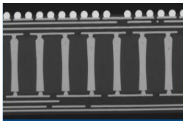
图 2：英特尔75 μm间距/3层RDL的玻璃基板
