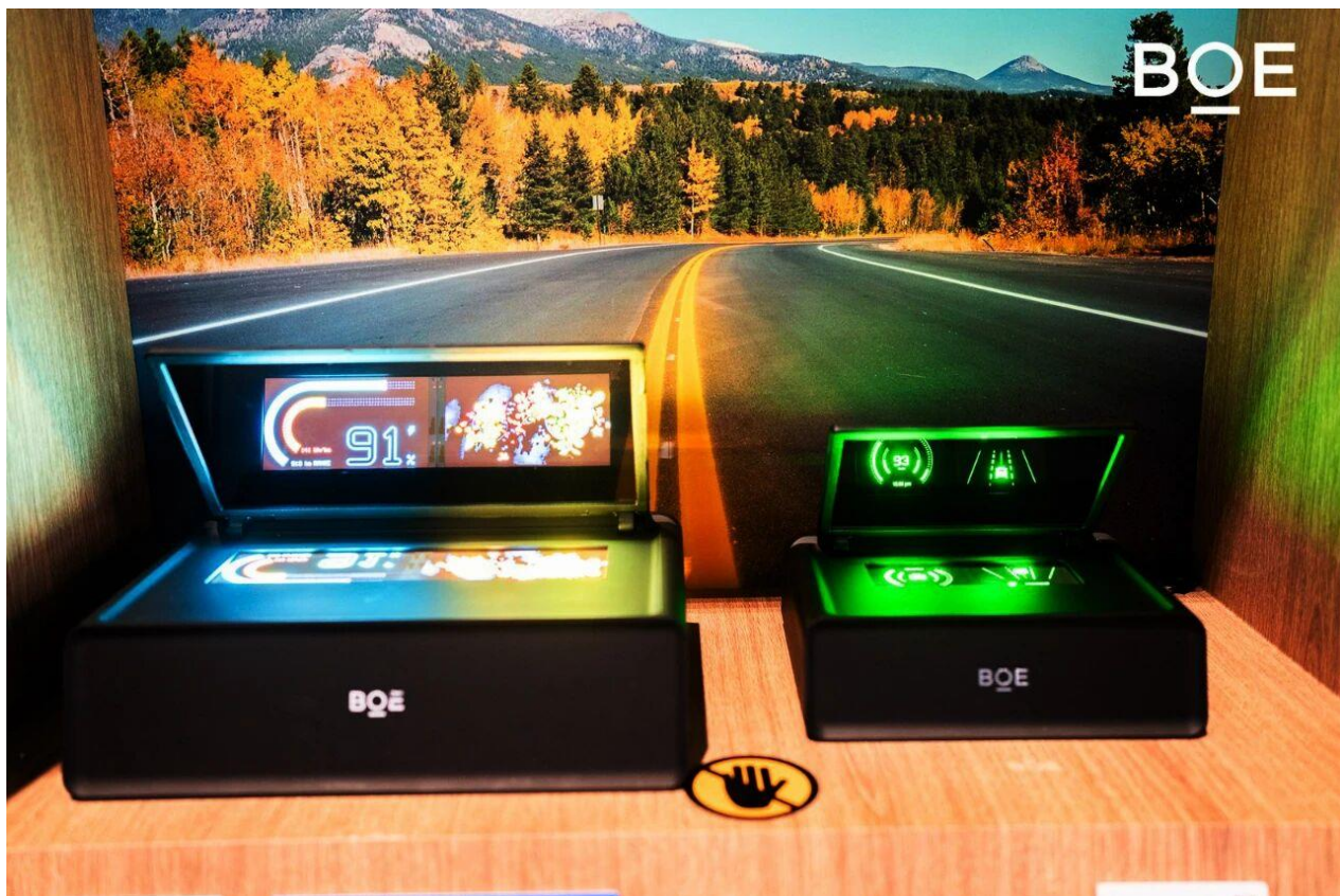
图 19: BOE 6.2 英寸高亮 RGB Micro LED HUD (左) 和 30 万 nits 超高亮单色 Micro LED HUD (右)
