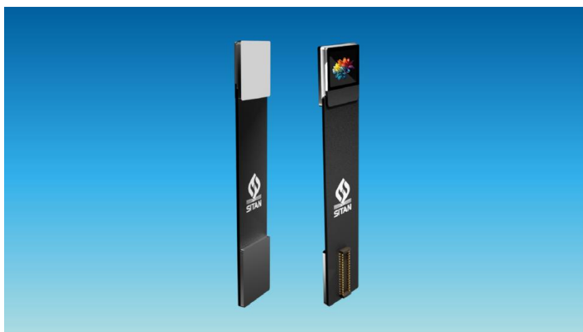
图25: 思坦科技于 2025 年 SID 国际显示周展示的 0.2"全彩 Micro-LED 模组, 分辨率 320*320, 亮度超 20 万尼特
