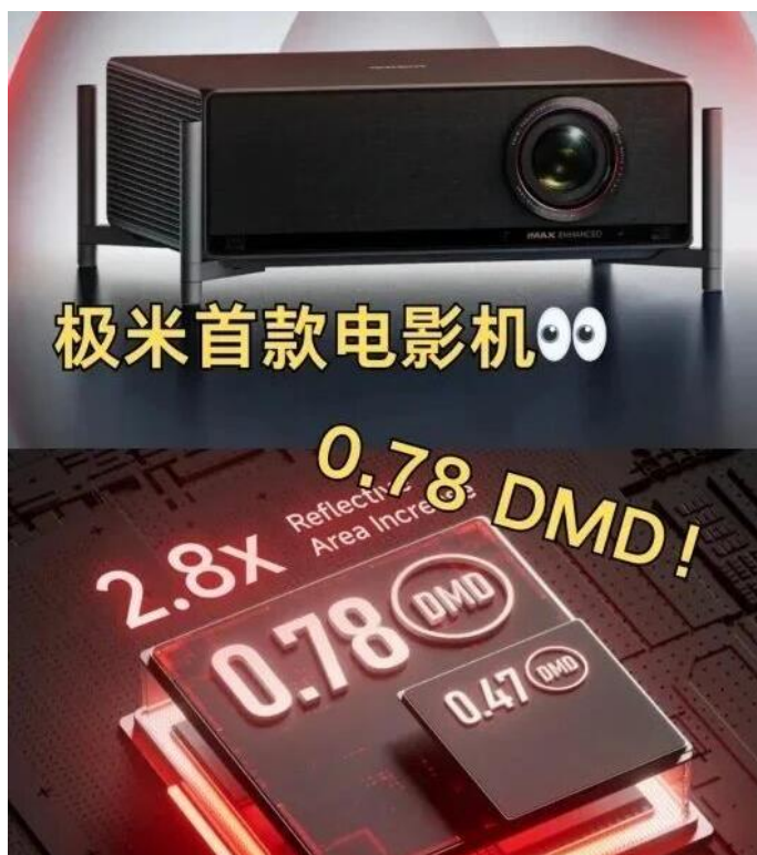
图18: 国内主流的投影机均采用德州仪器的 DMD 显示芯片
