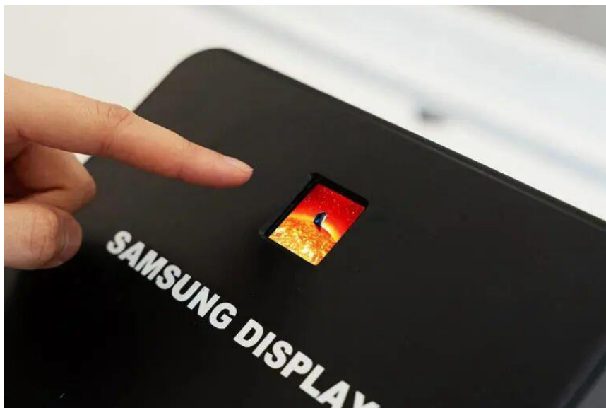
图12：三星显示在 SID 2025 显示周上展出的业界最高 5000PPI 的 RGB Micro OLED 面板
