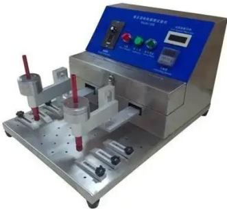
钢丝绒耐磨测试（1kg/2cm*2cm）
